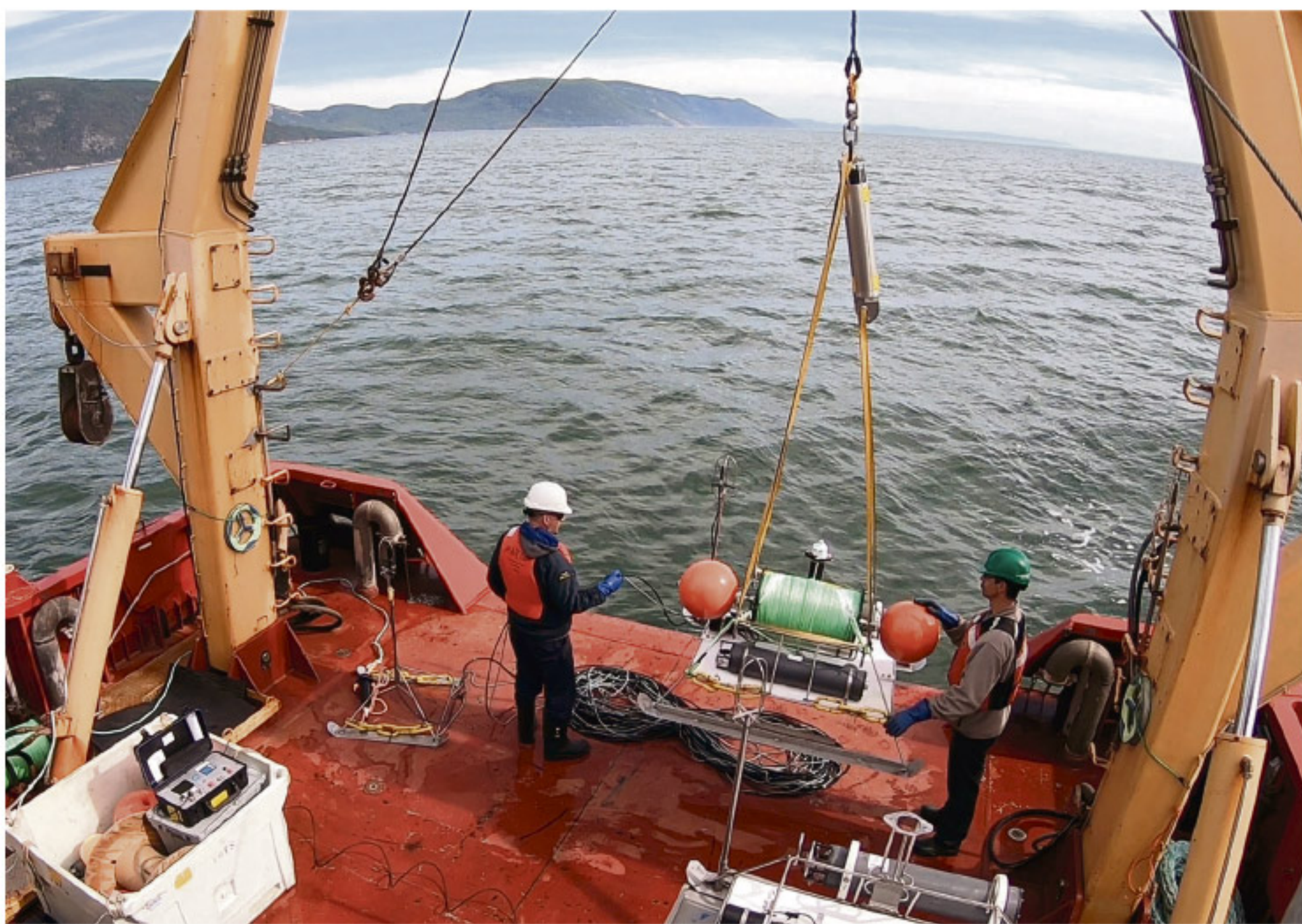
Déploiement d'une plateforme acoustique benthique entre Baie-des-Rochers et l'Île Blanche, réalisé à bord du NGCC LEIM de la Garde côtière par l'équipage du Leim et l'équipe du laboratoire d'acoustique sous-marine de l'Institut Maurice-Lamontagne en juin 2018 dans le cadre du Plan pour la Protection des Océans. Photo : Line Bourdages, Pêches et Océans Canada.
