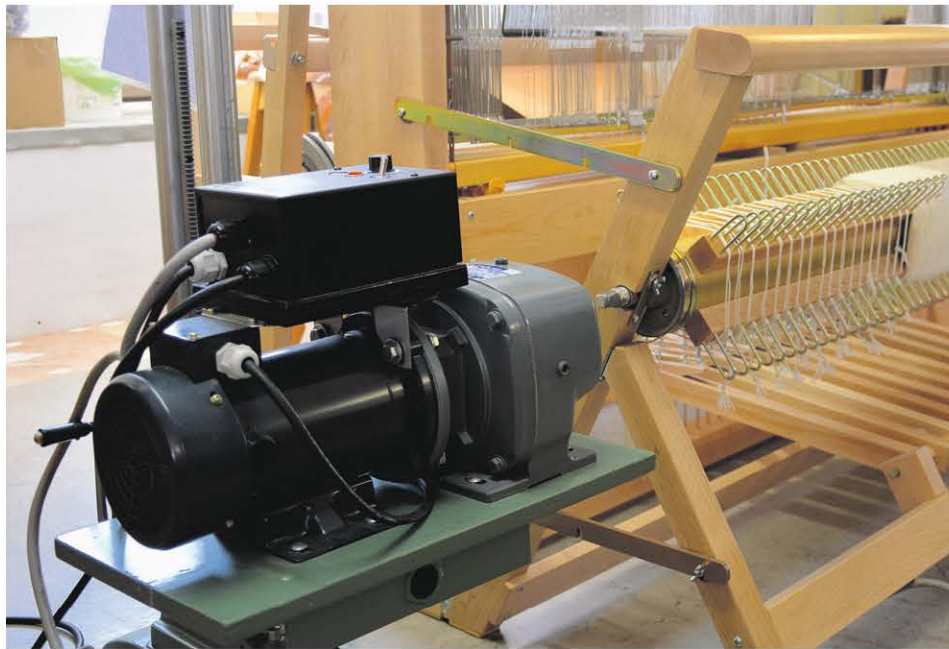
La machine accrochée au métier pour le faire tourner. Photo : Maxime Paradis.
